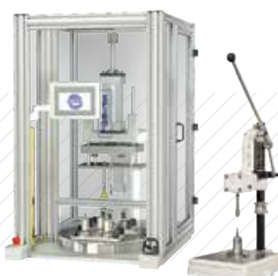
Technologie pro Instalaci Výztužných Sloupků
